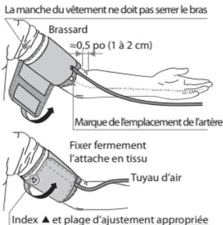
3. Placer le brassard directement contre la peau, car les vêtements peuvent provoquer une détection de pouls faible et entraîner une erreur de mesure. La constriction du bras, causée par une manche de chemise roulée, peut empêcher une lecture précise.
